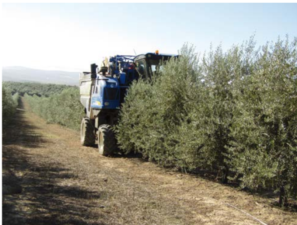
Figura 1. Plantación de olivar en seto donde la aceituna es recogida por una máquina cabalgadora.
