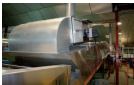
Unidad de lavado-encerado-secado de cítricos.
