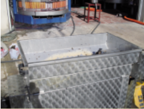
Estrujadora-despalilladora usada en las microvinificaciones.
