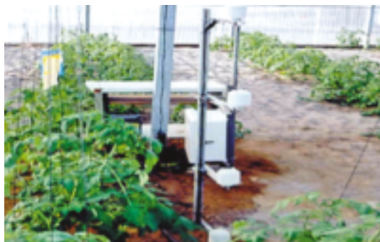
Fig. 2.4. Estación de control climático.
