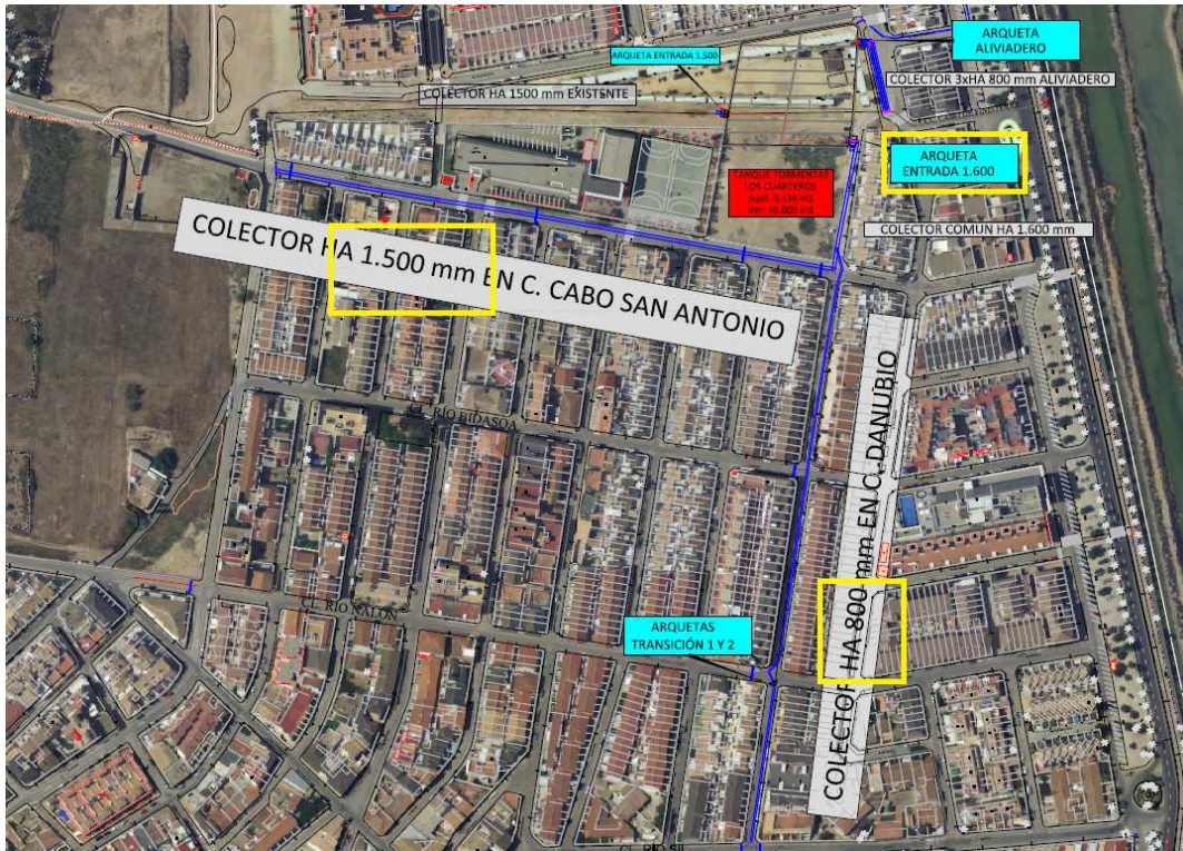
Figura 8.- Plano de actuaciones del “Proyecto de colectores y tanque de tormentas en Los Cuarteros, TM de San Pedro del Pinatar”, aportado por la D. G. del Agua.
