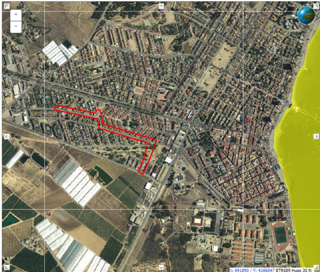
Figura 7: Colector de pluviales en el barrio de Los Pescadores (T.M. de San Javier, Murcia). Proyecto en relación con la zona de inundación marina (T=500).
