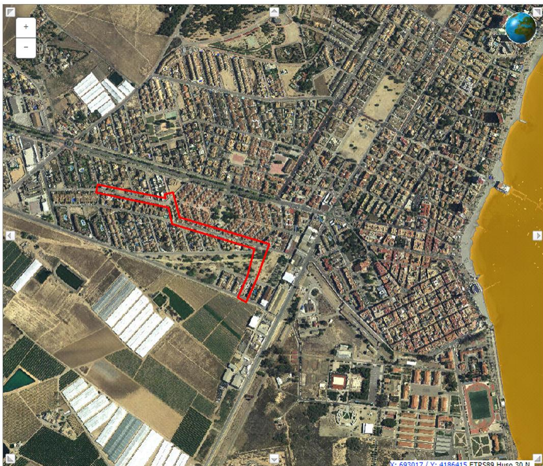
Figura 6: Colector de pluviales en el barrio de Los Pescadores (T.M. de San Javier, Murcia). Proyecto en relación con la zona de inundación marina (T=100).
