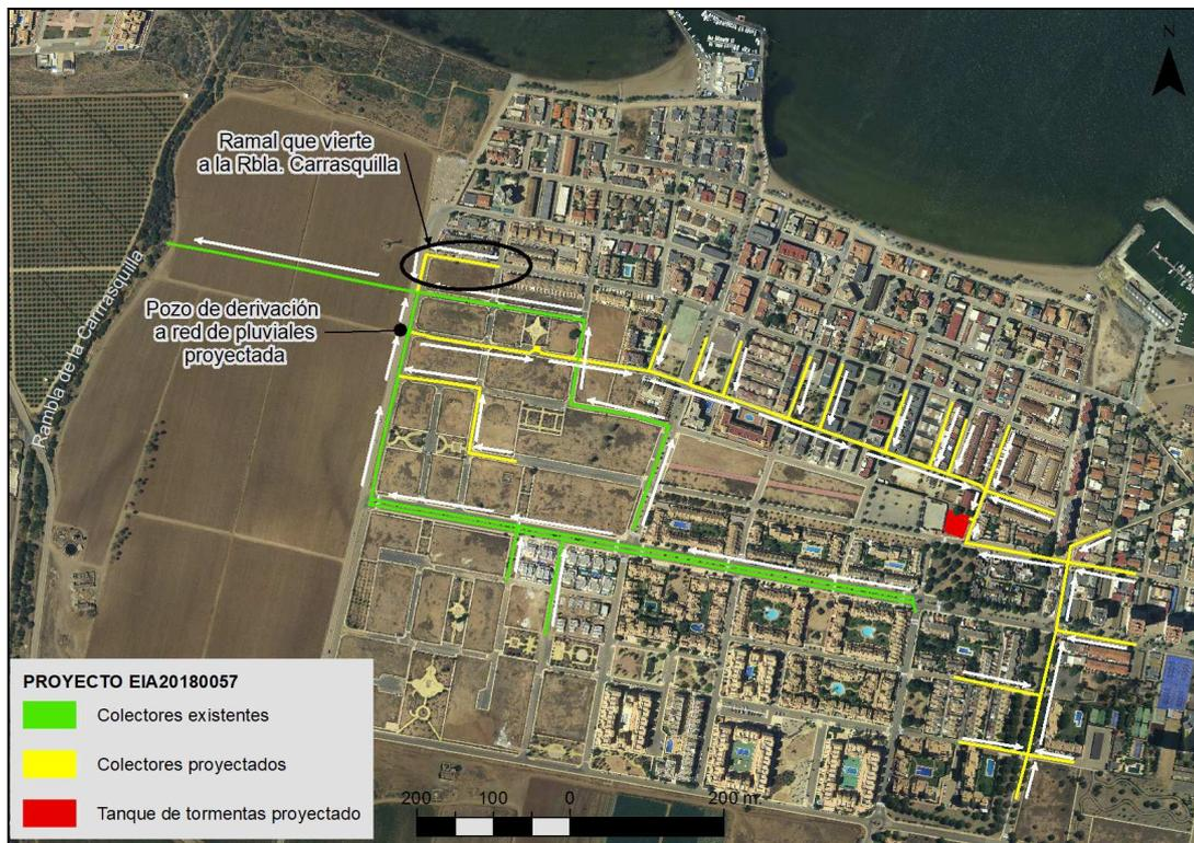
Figura 3.- Infraestructuras proyectadas en el "Proyecto de Colectores y Tanques de Tormentas Islas Menores-Mar de Cristal " (EIA20180057), sobre ortofoto PNOA'16. Fuente: Proyecto Técnico aportado por la D. G. del Agua.
