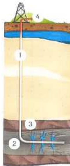
Figura 1. Etapas en la perforación del fracking. 1: Construcción de un pozo vertical hasta alcanzar la formación que contiene el gas. 2: Se dirige entonces la perforación en dirección horizontal, paralela a la estratificación. 3: Se inyecta el agua a presión con arena y productos químicos. 4: La presión se libera y el agua vuelve a la superficie cargada de gas.
