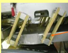
**Instalación de vibradores de alimentación a máquinas con elementos tipo "ballestas de plástico".**
