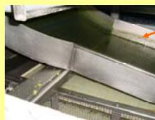
**Sustitución de rampas metálicas de caída de producto por otras de teflón**
