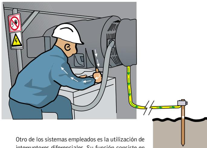
Otro de los sistemas empleados es la utilización de interruptores diferenciales. Su función consiste en detectar la existencia de corrientes de derivación a tierra y abrir el circuito eléctrico, para eliminar el riesgo de un accidente por contacto indirecto.
