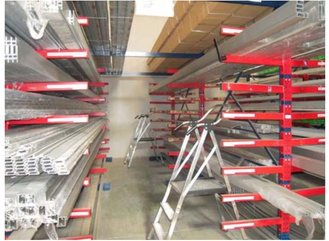
Fotografía nº 4: Escaleras de acceso a zonas superiores a 160cm destinadas a cargas de poca rotación y peso < 20kg.
