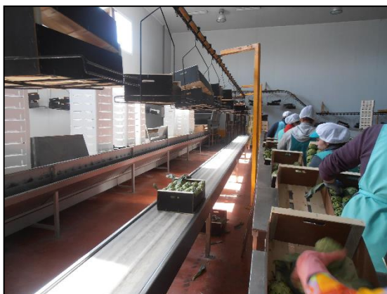
Cinta transportadora paralela al puesto de encajado
