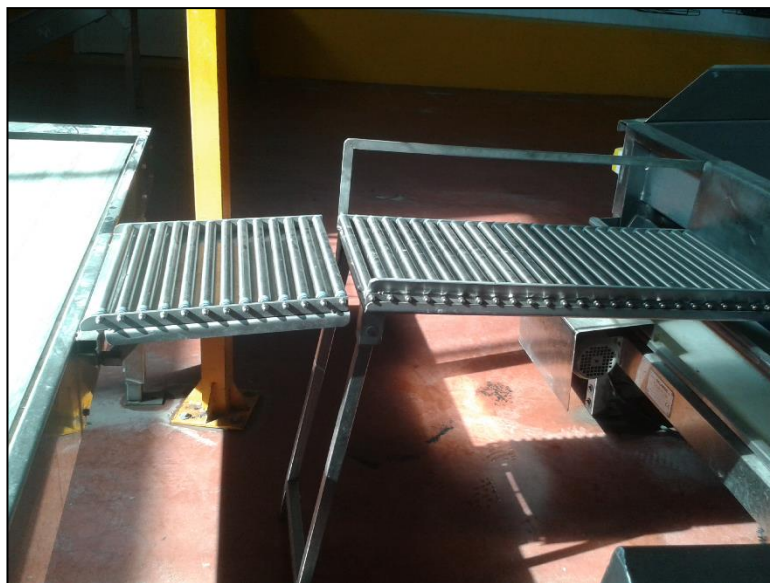
Plataforma con base de rodillos con la que se une la cinta transportadora y la línea de encajado.
