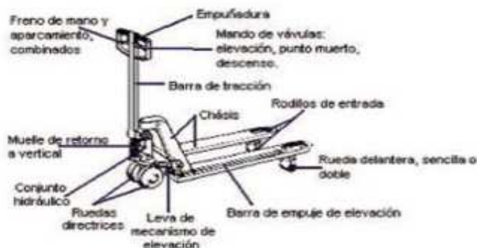
Foto 2. Partes de una transpaleta manual
